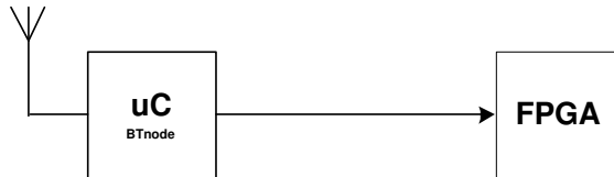
Abbildung 5: Konzept: FPGA soll via BTnode Mikrokontroller programmiert werden
