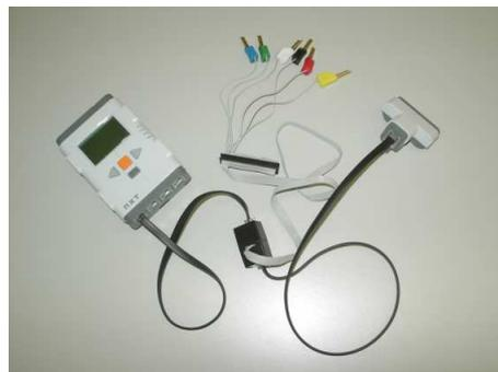
Abbildung 3.16: Bild des T-Steckers zum Anschluss an ein Oszilloskop
