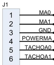
Abbildung 3.1: Schema eines Ausgangsports im NXT-Baustein
