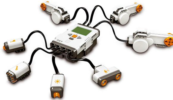
Abbildung 2.4: NXT-Baustein mit angeschlossenen Sensoren und Motoren
