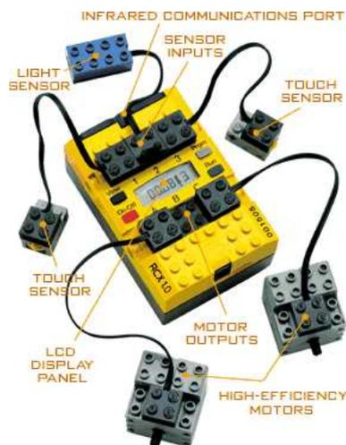
Abbildung 2.1: Erster programmierbarer LEGO Baustein (RCX) mit angeschlossenen Sensoren und Motoren
