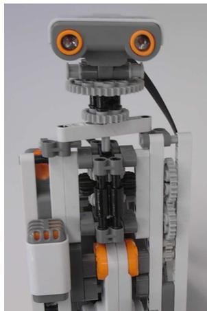
Abbildung 4.3: Bild des Sensorturms
