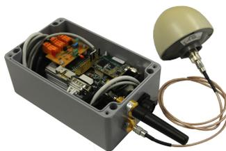
Figure 1: GPS-equipped Sensor Node Prototype.
